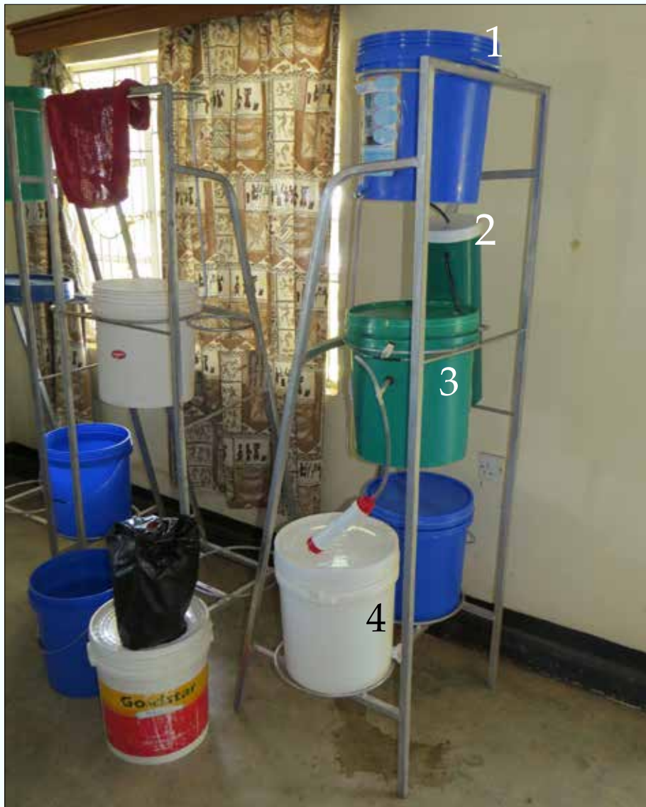
Muundo wa chujio la maji maarufu kama Nano filter ambalo limehakikiwa kuwa na uwezo wa kuchuja maji na kuondoa taka na kemikali za aina yoyote.
