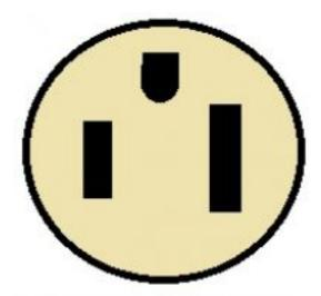
15 AMPERE, 125 VOLT, NEMA 5-15R RECEPTACLE, CAN BE USED ON 15 AMPERE MAXIMUM BRANCH CIRCUITS. THE TALLER SLOT IS THE GROUNDED CONDUCTOR SLOT
