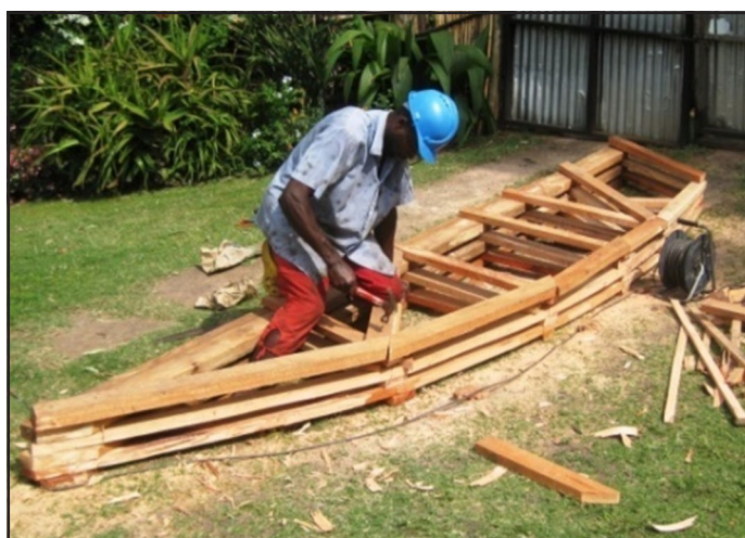
kielelezo 43 : Mara muundo wa kwanza ukishatengenezwa, mingine inakopiwa na kuundwa na kwa kutumia panga.
