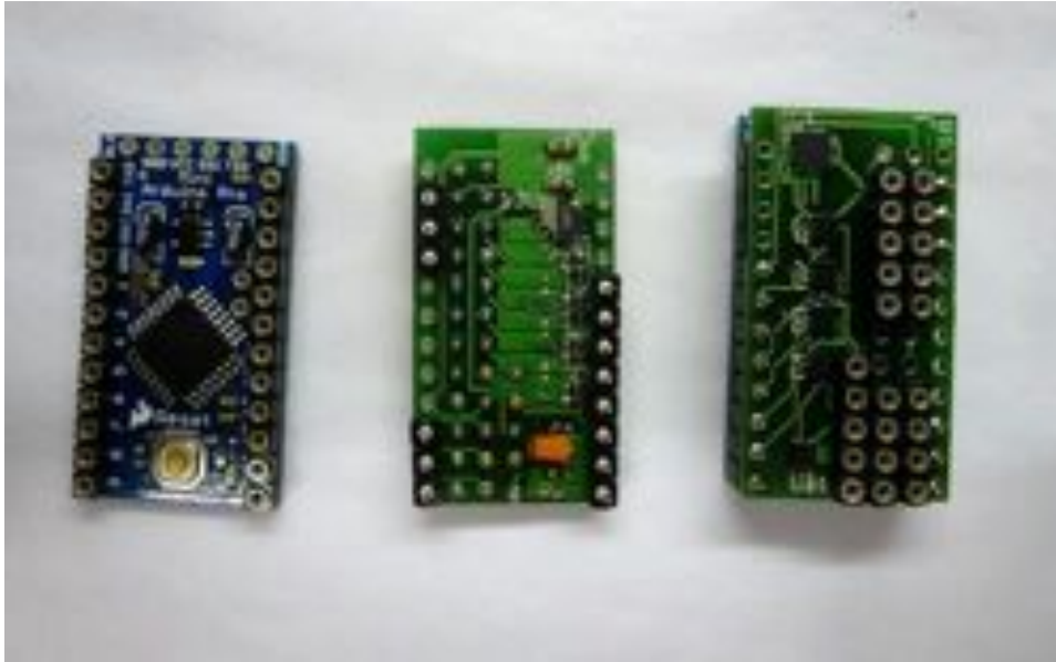
27 Dave Vondle, The Arduino Mini, Arduino Mini Shield, The Arduino Mini Shield placed on top of the Arduino Mini , 1.6 cm. x 3 cm. Photograph provided by IDEO
